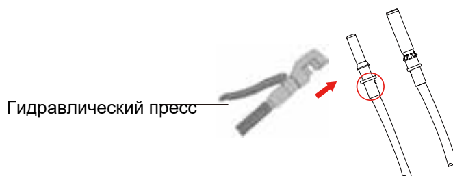
Рис. 5.4 Опрессовка контакта на проводе
